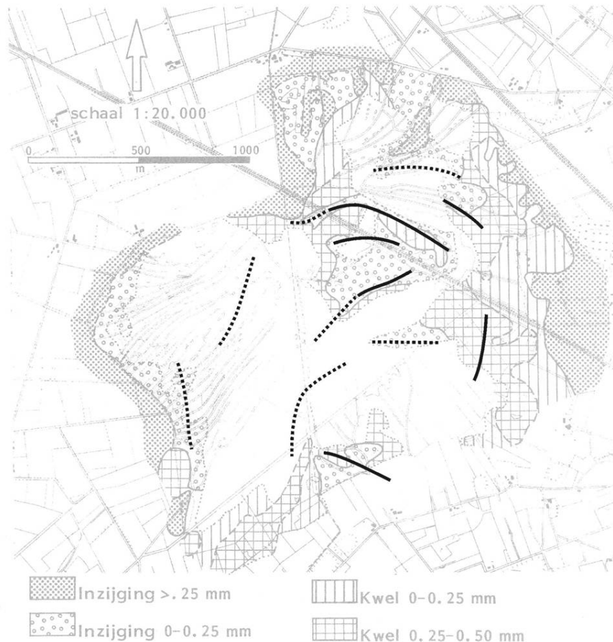
Figuur 3. Kwel en Inzijging in het Korenburgerveen en de ligging van dekzandruggen (naar Mankor, 1985). Gebiedsdelen die niet zijn ingekleurd zijn veengronden (met name vlietveengronden en vlierveengronden).
